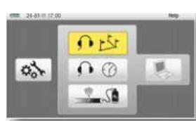
LD6000 запрограммирован на применение широкого спектра стандартных приложений, доступ к которым можно получить быстро и легко. Он также оснащен различными настройками фильтров и дополнительными параметрами, которые можно адаптировать к индивидуальным требованиям пользователя, и которые можно настроить либо с помощью сенсорного экрана, либо с помощью клавиш и кнопок на панели управления.
