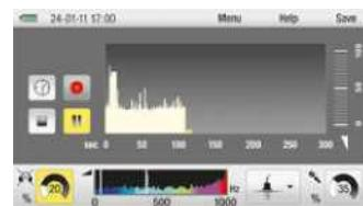
Для того, чтобы иметь возможность точно определить место течи, бортовой регистратор звука можно активировать для регистрации результатов измерений в течение периода до 60 минут, которые затем используются для определения или исключения любых течей с помощью записанной кривой измерения.
