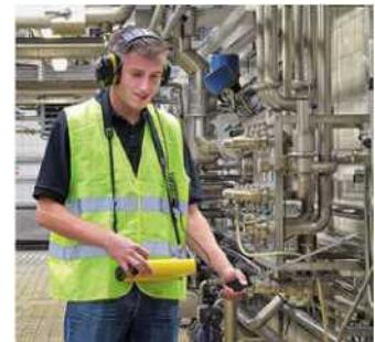
встроенным всасывающим насосом, который позволяет обнаруживать даже самые незначительные концентрации следов газа.
