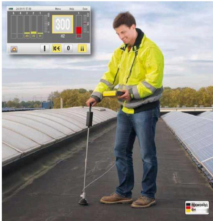
Для проведения чрезвычайно точного обнаружения утечек и малозатратных проверок герметизирующих листов, линий, контейнеров и резервуаров
